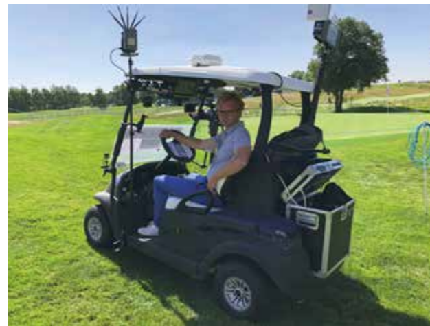
Dans un environnement contraint, les émetteurs portables ainsi que l'encodeur 4K HE4000 Aviwest peuvent s'utiliser avec une antenne externe Quad du même constructeur, comme ici lors du HNA Open de France de golf.
